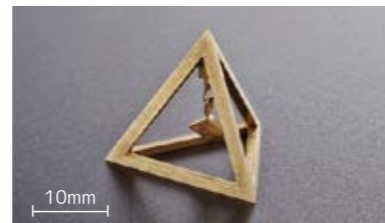
▲ カーブカット工法により削り出された 真鍮ピラミッド
